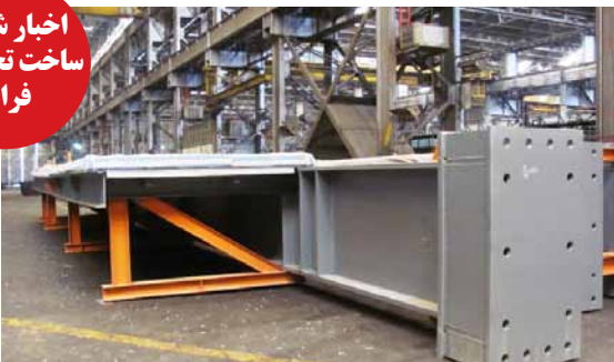
صفحات نصب شده اینلت داکت بویلر باز یافت واحد ۳
