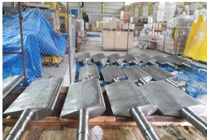
تمیزکاری قطعات و بکت گیت واحد اول توربین
