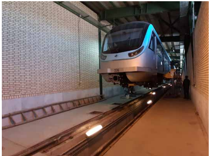
تعویض موتور ترکشن معیوب قطار ۲۰۴، تعمیر موتور ترکشن قطار ۲۰۶ (۵)
