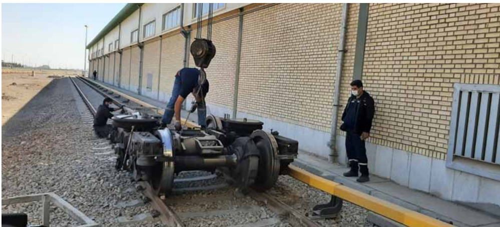
تعویض موتور ترکشن معیوب قطار ۲۰۴، تعمیر موتور ترکشن قطار ۲۰۶
