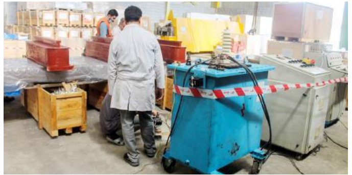
تست الکتریکی قطب‌های روتور واحد اول
