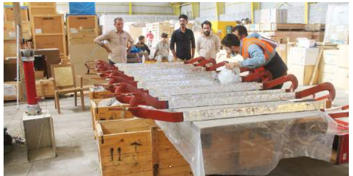
تست الکتریکی شینه‌های واحد
