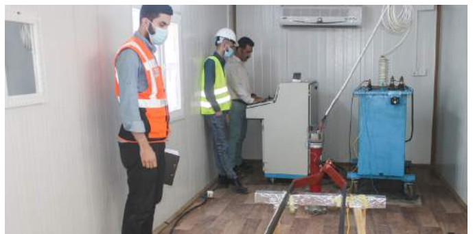
تست الکتریکی شینه‌های استاتور
