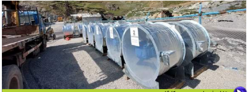
تخلیه فن های محوری در کارگاه
