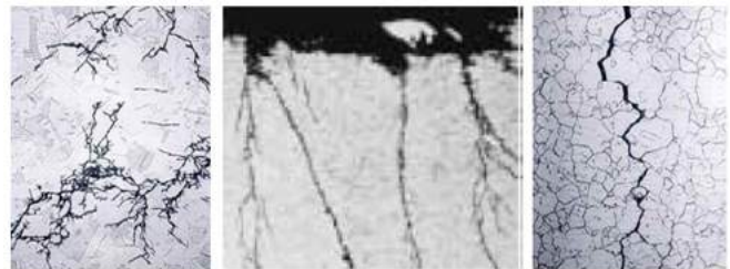
شکل ۶: نمونه‌های استاندارد مکانیزم تشکیل ترک در اثر SCC
