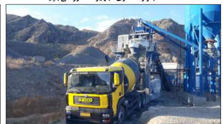
عملیات ساخت بتن در بچینگ
