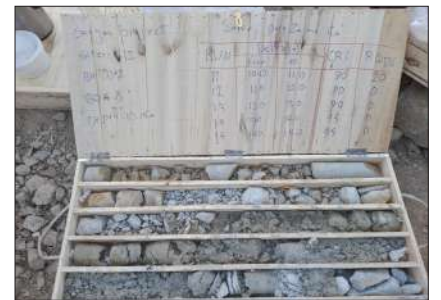
حفاری گمانه سدها و نمونه برداری
